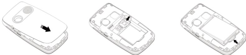
1. Entfernen Sie die Abdeckung des Akkufaches, indem Sie mit einem Fingernagel in die Aussparung an der unteren linken Seite fahren und den Deckel abheben.
