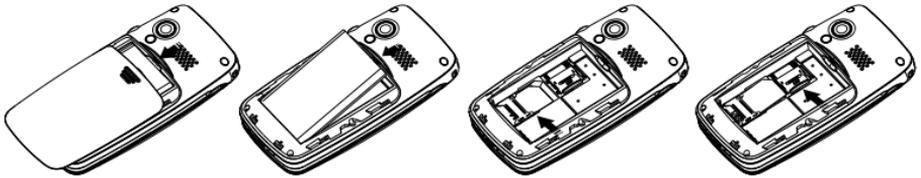
1. Entfernen Sie die Abdeckung des Akkufaches, indem Sie diese mit dem Daumen an der Riffelung auf der Rückseite des Telefongehäuses nach unten schieben.
