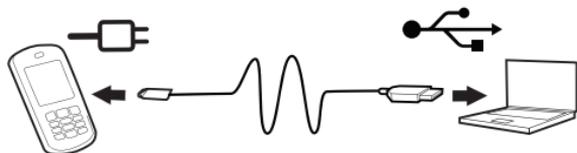
Verbinden Sie das Telefon mit einem Computer, um Bilder und Musik zu übertragen. Sie können das Telefon über ein optional erhältliches USB-Kabel mit dem Computer verbinden. Anschließend können Sie im Datei-Explorer des Computers mit der Funktion „Ziehen und Ablegen“ Daten zwischen dem Telefon und dem Computer kopieren oder verschieben.
